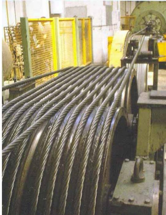
(allungamento anelastico) delle funi. Essa si realizza sottoponendo la fune a cicli di carico tali da assorbire le disuniformità di sollecitazione dei fili dovute al processo di produzione di trefoli e funi. Essa risulta particolarmente efficace nel caso di funi spirodali e chiuse.
